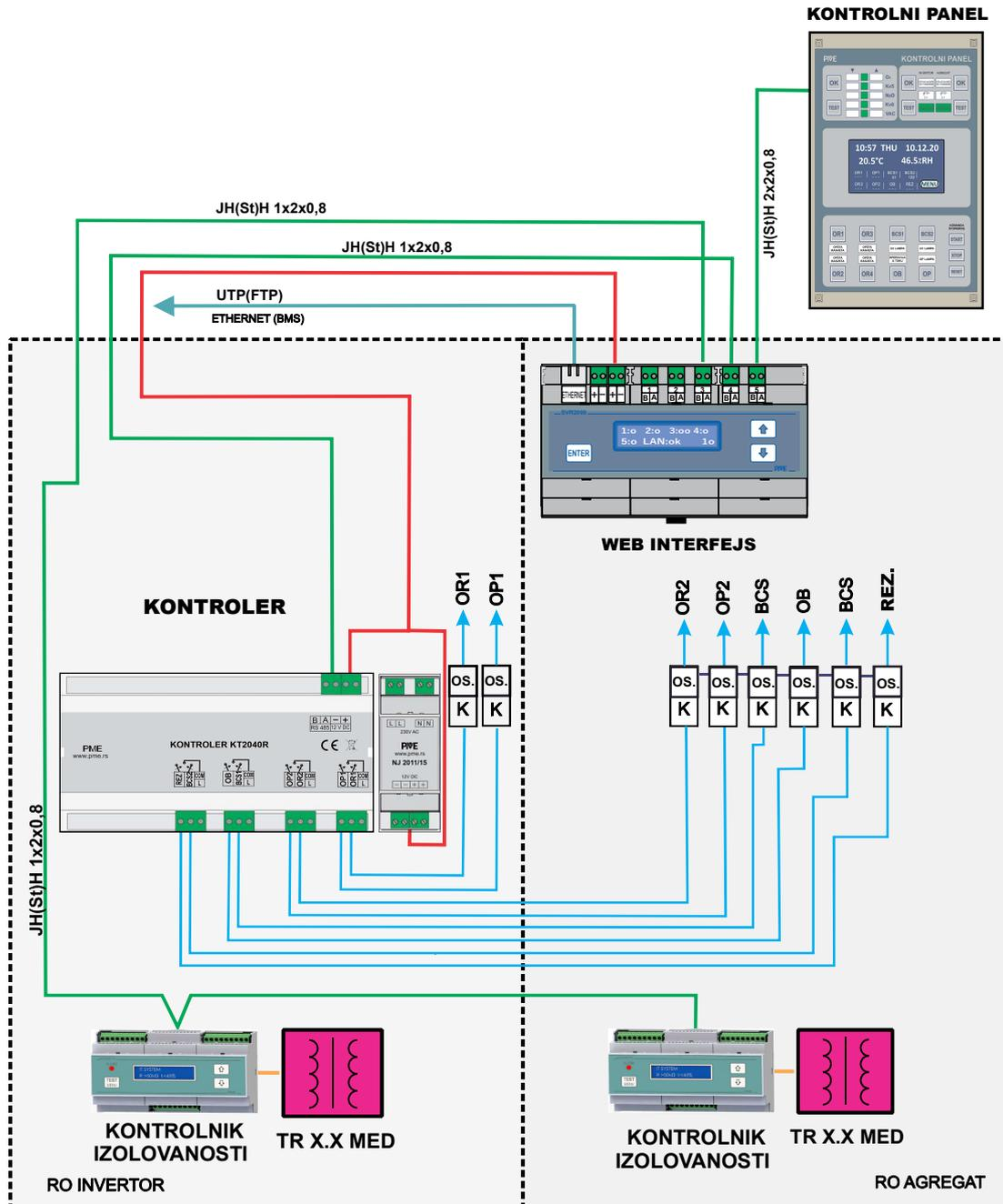
U okviru IT sistema napajanja, kontroler KT 2040R se priključuje na WEB interfejs SVR 2000, kako bi ostvario komunikaciju sa signalno-komandnim središtem IT sistema napajanja u medicinskim lokacijama (Kontrolni panel TO 2100) i sistemom centralnog nadzora i upravljanja (BMS). Za povezivanje kontrolera KT 2040R sa tehničkim ormanom koristi se Interfejs/protokol RS-485, pa je time neophodno interno ožičenje instaliranjem jedne žičane parice od pozicije kontrolera do pozicije tehničkog ormana.
